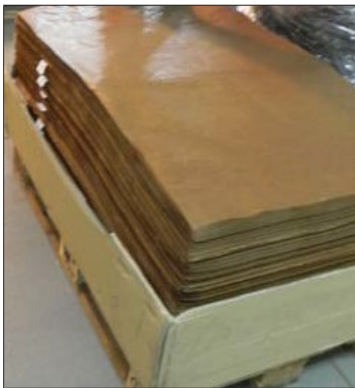
Beispiel einer gewachsten Zwischenlage (nicht zulässig)
