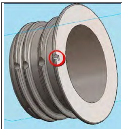
Fig. 12: Entalhe na parte inferior
