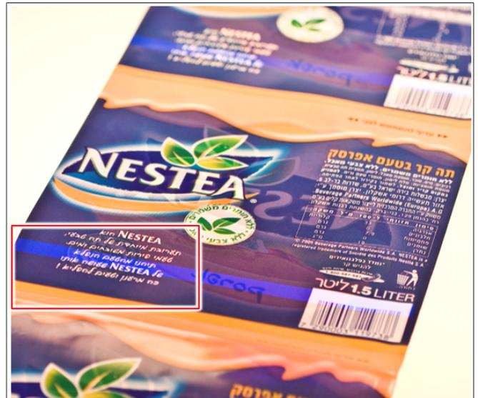
Fig. 117: Marca de corte luminiscente legible
