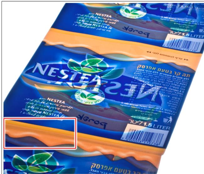
Fig. 116: Marca de corte luminiscente legible
