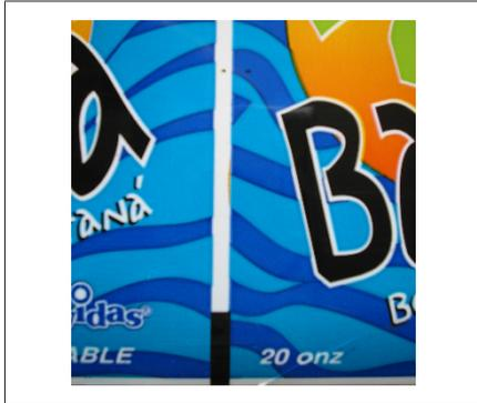
Fig. 91: Más de un color dentro del área de exploración antes y después de la marca de corte y contraste de color insuficiente
