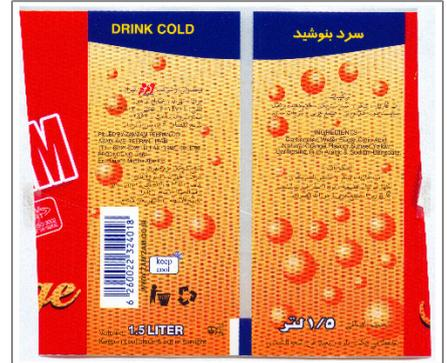
Fig. 93: Más de un color dentro del área de exploración antes y después de la marca de corte y tamaño mínimo del área de exploración no contemplado
