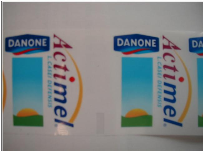
Abb. 89: Beispiel für ein transparentes Etikett mit unbedruckter, transparenter Schnittmarke
