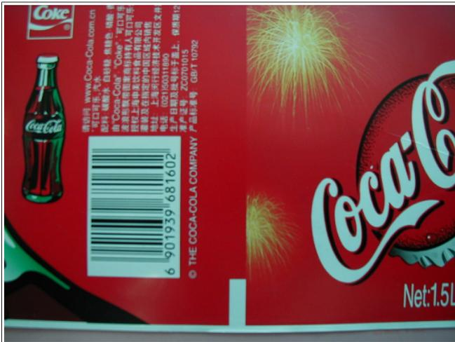
Opake Polypropylenfolie mit Schnittmarke an der Etikettenunterkante. Erkennbarkeit nur durch Setzen eines Fensters durch die Schnittmarkenerkennung möglich. Ausgelegt für eine Maschinenlauf- richtung rechts-links Etikettengrundfarbe Rot im Abtastbereich vor und nach der weißen Schnittmar- ke.
