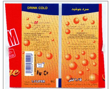
Abb. 93: Mehr als eine Farbe im Abtastbereich vor und nach der Schnittmarke und Mindestgröße des Abtastbereiches nicht berücksichtigt
