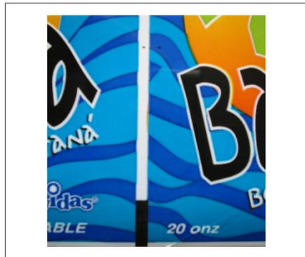
Abb. 91: Mehr als eine Farbe im Abtastbereich vor und nach der Schnittmarke und Farbkontrast nicht ausreichend
