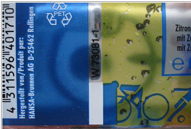
Opake Polypropylenfolie mit Schnittmarke an der Etikettenunterkante. Erkennbarkeit nur durch Setzen eines Fensters durch die Schnittmarkenerkennung möglich. Ausgelegt für eine Maschinenaufrichtung links-rechts. Etikettengrundfarbe Blau im Abtastbereich vor und nach der weißen Schnittmarke.
